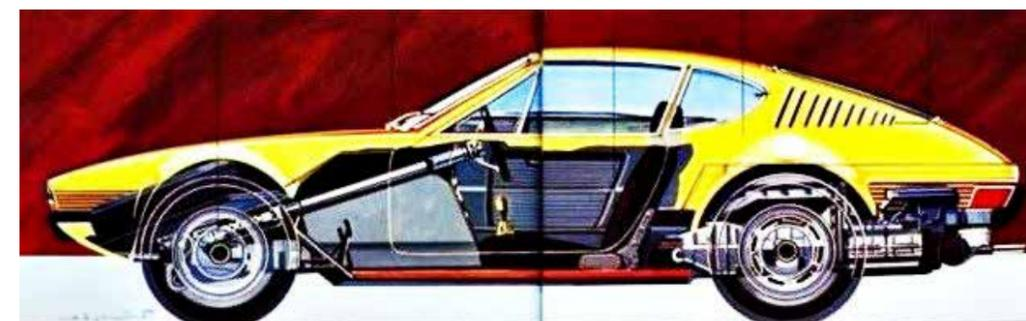
No desenho em “raio X”, observa-se que a configuração mecânica é basicamente semelhante a todos os carros da marca naquela época. No entanto, devido à altura reduzida do carro, algumas mudanças na configuração mecânica foram necessárias. O radiador de óleo foi colocado na horizontal, e alguns periféricos, como a bobina e a bomba de combustível, foram reposicionados. Os carburadores e o filtro de ar tiveram que ser redesenhados.
